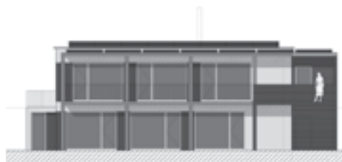
Der grosse Balkon an der Südfassade dient im Sommer der Beschattung.
